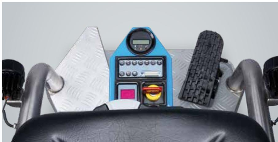
La vitesse d'entraînement peut être contrôlée graduellement depuis la pédale ergonomique jusqu'à 10 km / h. Le repose-pieds pour le pied gauche est incliné, ce qui permet d'avoir une prise sûre, même en terrain escarpé.
